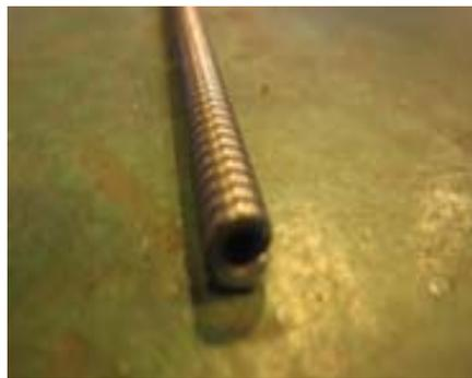
コイルガイド敷設後、熱電対が挿入されたワイヤガイドをコイルガイド内部に通す
