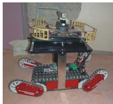
東北大田所先生と共同で、 小型ヘリとクローラ型ロボット を組合せ、地震で損傷した建 物内の3次元地図を遠隔取 得する実験を行い成功してい る
