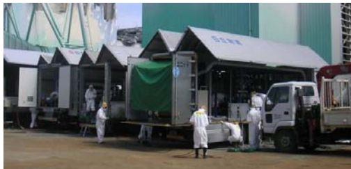
塩分除去 逆浸透膜(RO)装置
