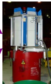
チェルノブイリで、国際協力により開発が進められている核物質質量測定装置
