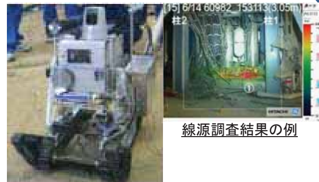
線量率、線源調査ロボット
