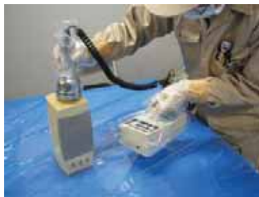
工業製品の残留放射線量測定 (GMサーバイメーター)
