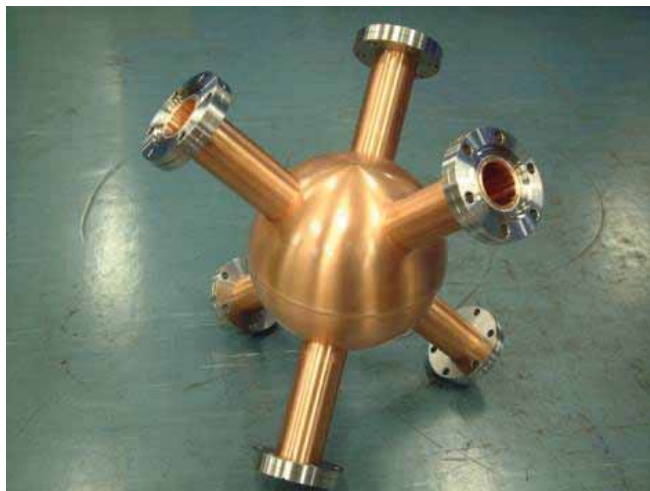
銅パイプと銅本体は、 本体内部から溶接
