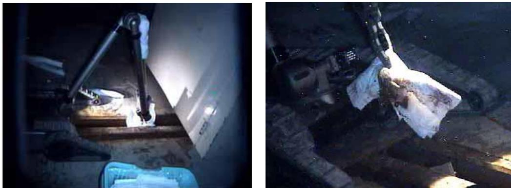
図 (ミッション③) 3号機原子炉格納容器機器ハッチレールの拭取り作業<sup>[6]</sup>
