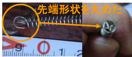
挿入抵抗低減対策(先端スプリング形状変更)
