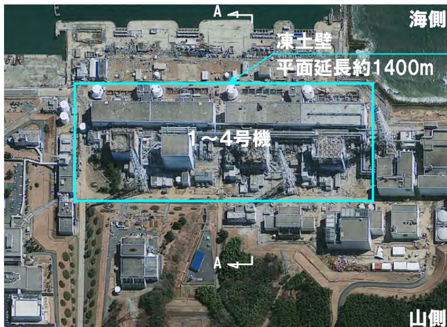
[凍土による陸側遮水壁の配置図(出典:鹿島建設、写真提供:東京電力)]
