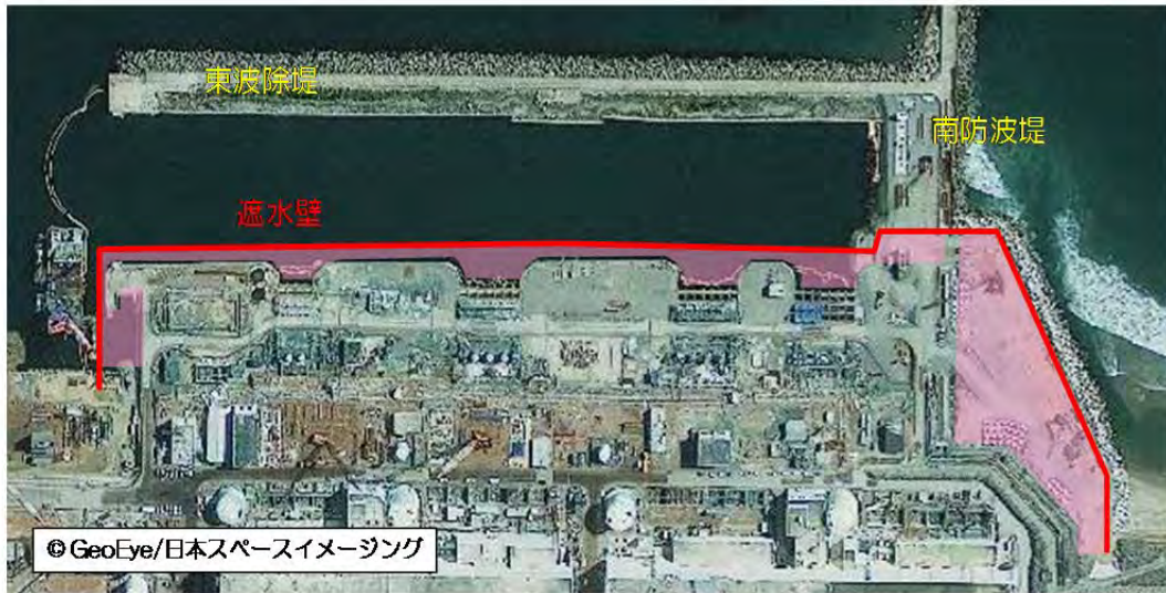
[海側遮水壁の配置図(出典:東京電力)]
