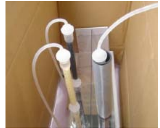
ホットラボでの 吸着除去性能確認試験
