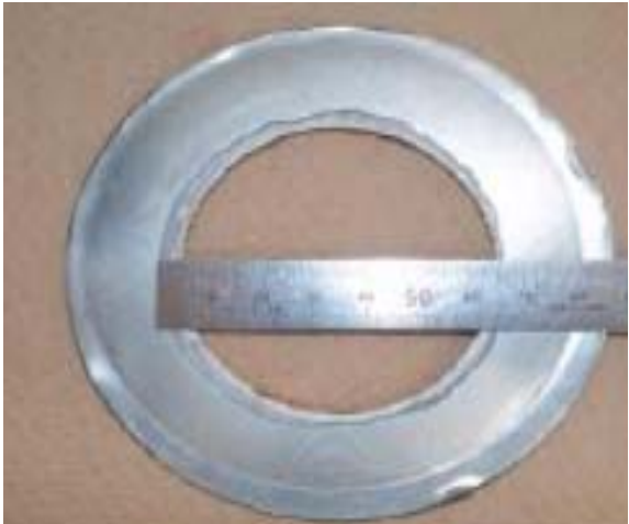
②スラリー移送ポンプ出口配管 ガスケット型犠牲陽極
