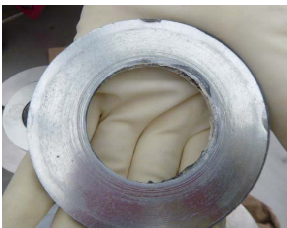
⑫処理カラムベント配管 ガスケット型犠牲陽極
