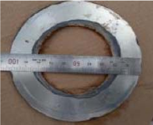
⑦供給ポンプ1出口配管 ガスケット型犠牲陽極
