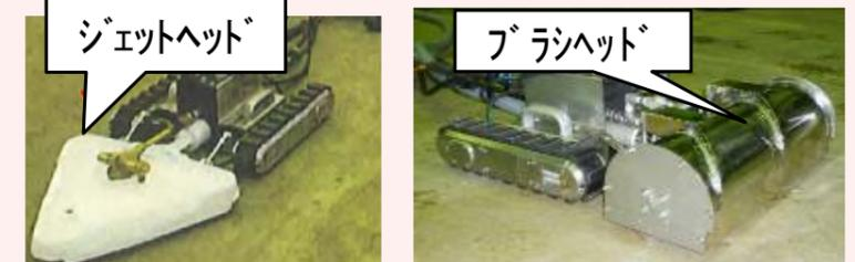
効果を確認した遠隔操作除染装置（ラクーン）
