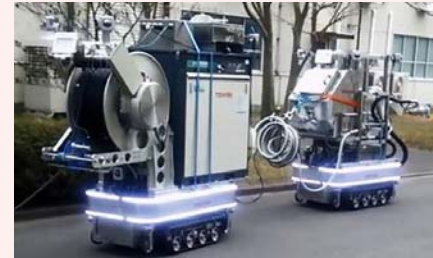
ドライアイスプラスト除染装置
