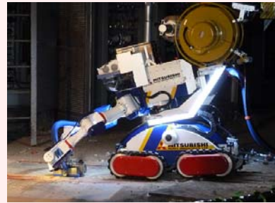
吸引・プラスト除染装置
