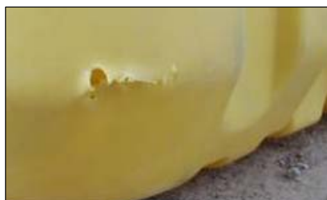
上 : 再現テスト状況 右上 : H5エリアで漏洩したタンクの損傷 右下 : 再現テストにおけるタンクの損傷
