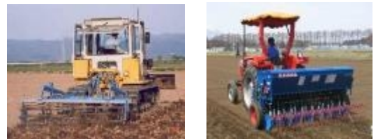
大型機械による低コスト作業体系実証 (スタブルカルチ、グレートリルによる高速作業)
