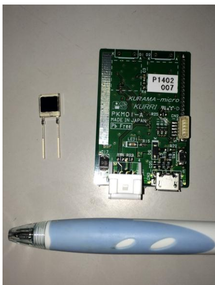
図5 KURAMA-microの放射線検出部。これにGPSや通信モジュール等を組み合わせたものになる。
