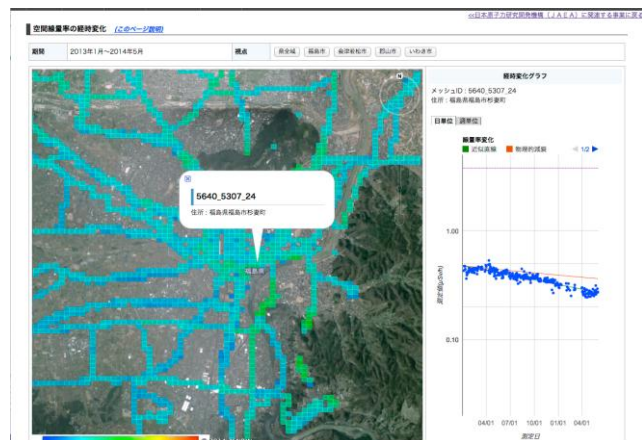
図4 京大運用の路線バス搭載 KURAMA-II データが JAEA サイトからも配信中。
