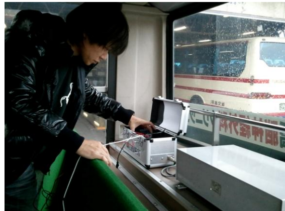
図1 (左) KURAMA-II のシステム構成図。(右) 路線バスに設置される KURAMA-II。
