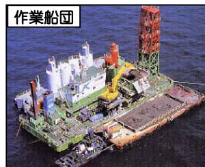
福島第二にスラリープラントを設置した海上施工システム（被覆材Aの場合）
