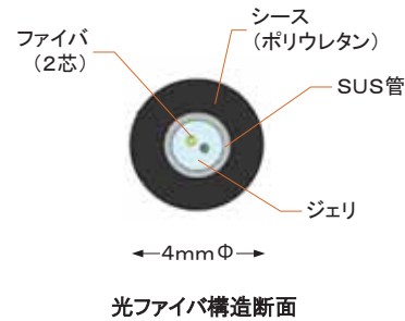
光ファイバ構造断面
