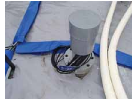
FS①における測温管状況 (左:測温管頭部キャップ、右:測温管構造)
