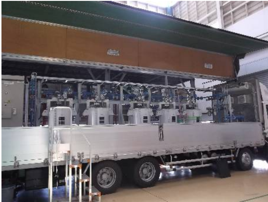
検証試験装置用吸着塔ユニット
