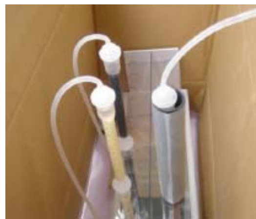
吸着除去性能確認試験装置
