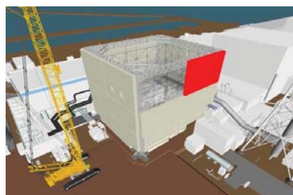
②壁パネル解体開始
