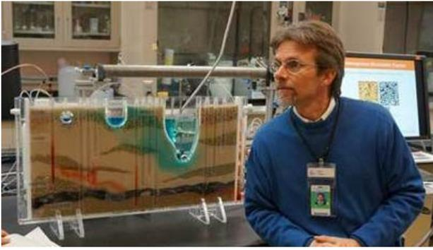
汚染水対策の研究：さまざまな種類の土壌、地下水と表面水は相互作用を持っている（写真の青と赤の染料の挙動が違う）。化学的、物理的な挙動を調べることが重要で、どういう方法で浄化作業を行うのが一番良いかを見極める。
