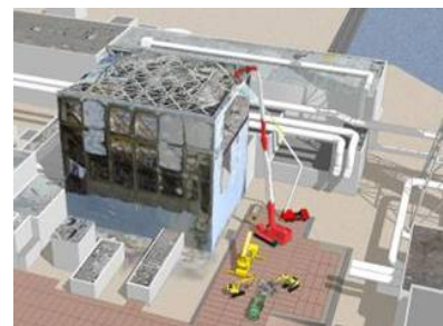
原子炉建屋上部のガレキ撤去
