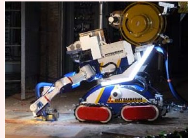
吸引・プラスト除染装置
