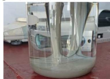
水中に充填材を直接投入しても材料は分離しない
