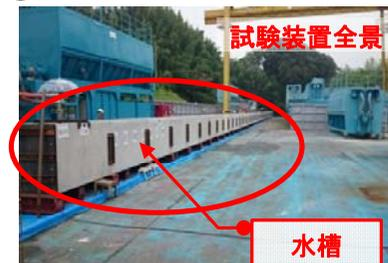
約100mの水槽の片側から充填材を打設し、反対側から到達を確認し、充填材の状況を確認
