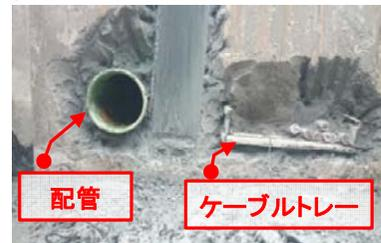
水槽による充填試験により、配管等のすき間にも充填
