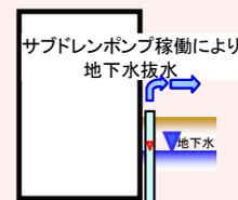
サブドレン水汲み上げによる地下水位低下に向け、サブドレン他水処理施設の安定稼働の確認のための試験を実施。浄化により地下水バイパスの運用目標を下回ること、その他γ核種が検出されないことを確認。サブドレン水を汲み上げることによる地下水流入の抑制
