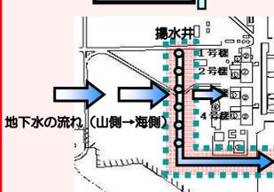
山側から流れてきた地下水を建屋の上流で揚水し、建屋内への地下水流入量を抑制する取組(地下水バイパス)を実施。くみ上げた地下水は一時的にタンクに貯留し、東京電力及び第三者機関により、運用目標未達であることを都度確認し、排水。揚水井、タンクの水质について、定期的にモニタリングを行い、適切に運用。建屋と同じ高さで設置した観測孔において地下水位の低下傾向を確認。建屋への地下水流入をこれまでのデータから評価し、減少傾向を確認。
