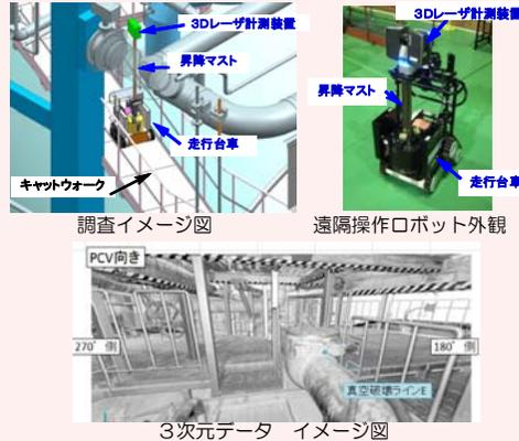
**圧力抑制室（S/C※1）上部調査による漏えい箇所確認**
