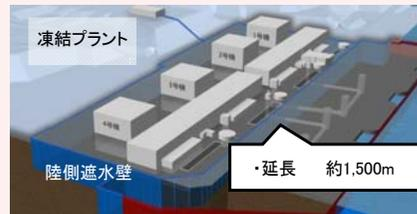
建屋への地下水流入を抑制するため、凍土壁で建屋を囲む陸側遮水壁の設置を計画。2014年度末の凍結開始を目指し、2014/6/2から凍結管の設置工事中。
