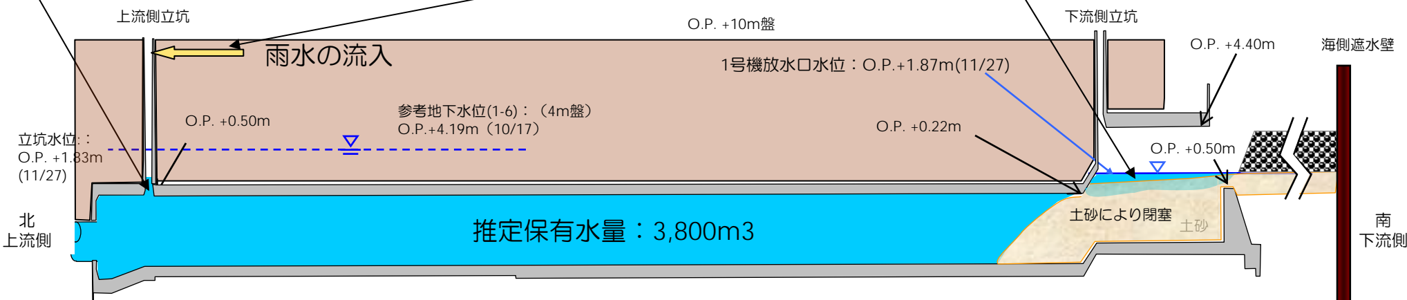
1号機放水路縦断図+水位+土砂堆積状況(縦横比1:5)
