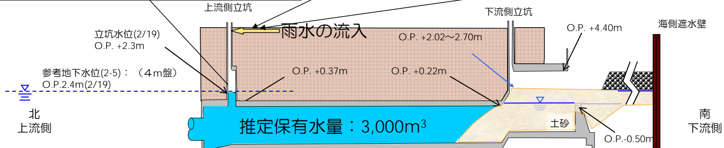
2号機放水路縦断面図+水位+土砂堆積状況(縦横比1:5)
