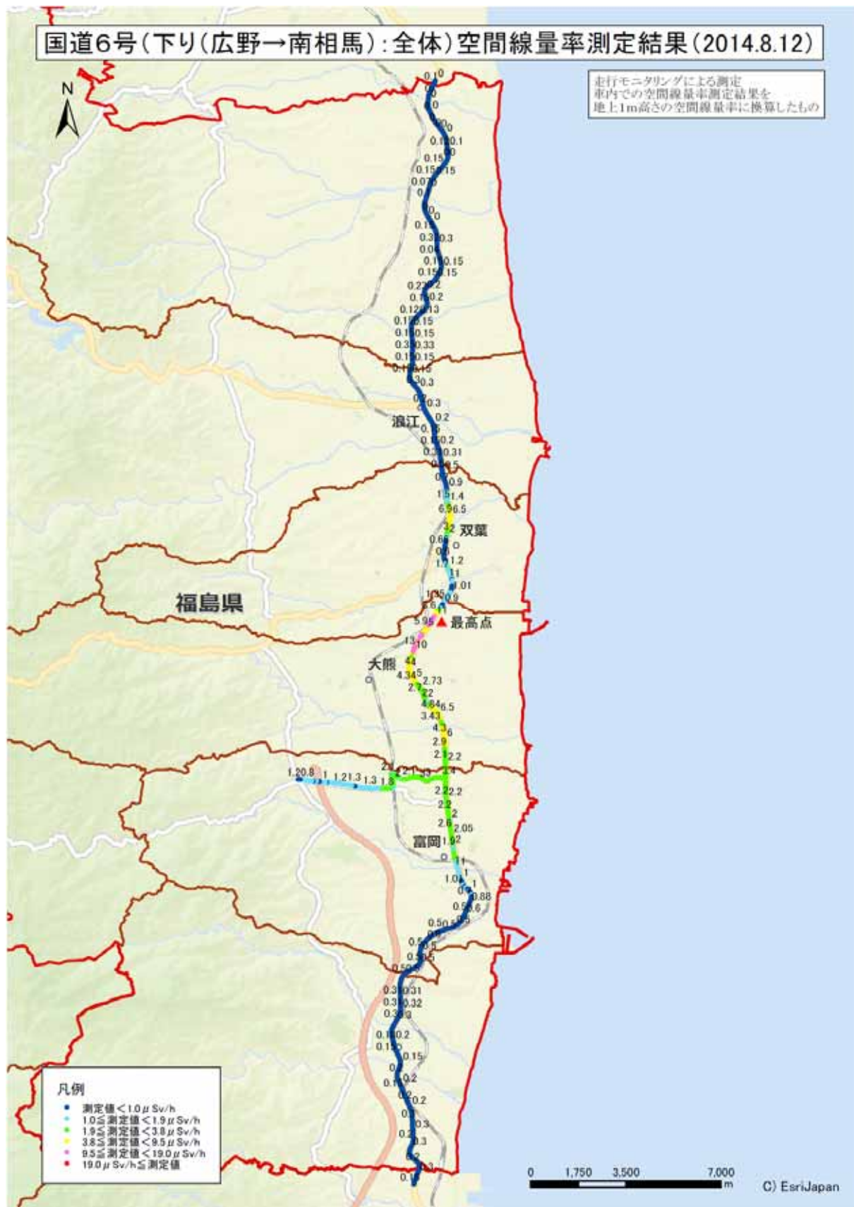
図2 走行時測定結果から算出した道路上の車外の空間線量率 (県道36号は常磐富岡 IC 入り口→国道6号)
