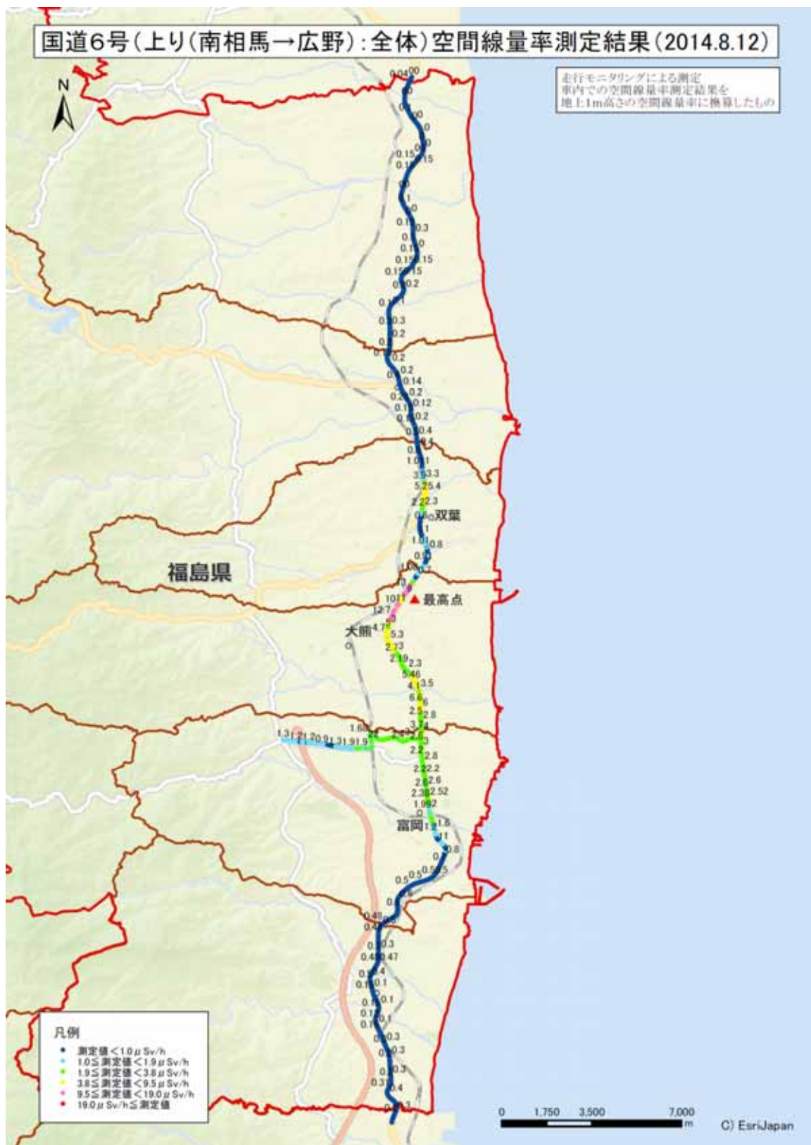
図3 走行時測定結果から算出した道路上の車外の空間線量率 (県道36号は国道6号→常磐富岡IC 入り口)
