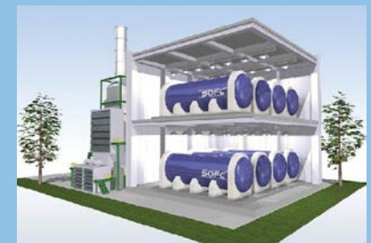
トリプルコンバインドサイクル発電に組み合わせる燃料電池のイメージ
