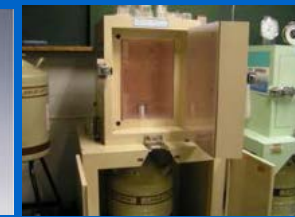
ゲルマニウム半導体検出機 製品中の放射能測定、放射性物質の種類特定。
