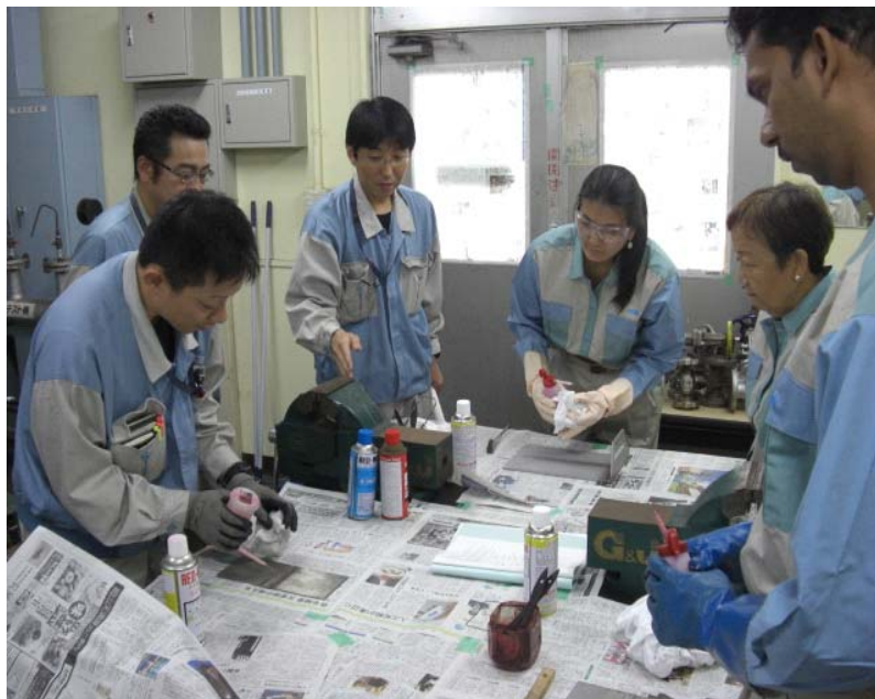
写真3 研修風景：液体浸透テスト実習
