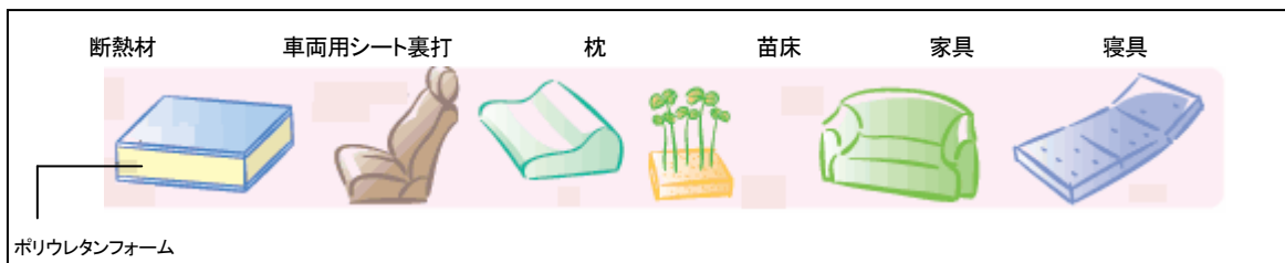
スラブ方式で製造される軟式ポリウレタンフォームの主な用途
