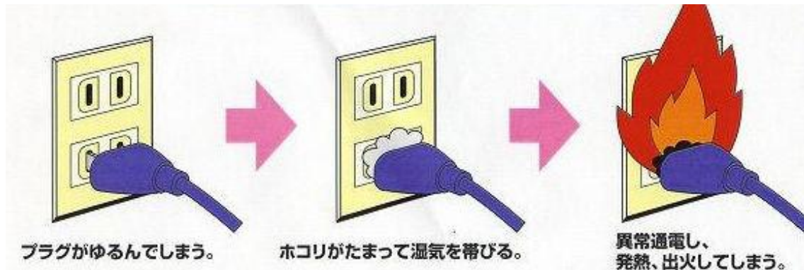
トラッキング現象による火災
