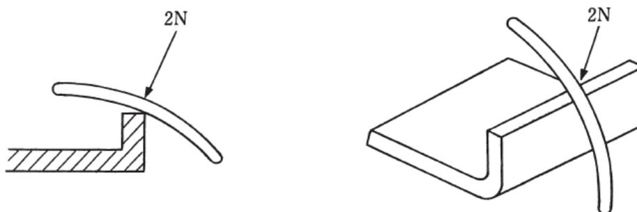
(b) 傷の判定は、試験後、接触した電線の被覆にチョークを塗布し、これを布でふきとり、そのあとにチョーク粉が残されているか否かによって行う。
