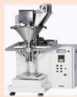
各種原料および製品を、一定の質量に分割して袋、缶、箱などの容器に充てん（ランダムな質量を取捨選択して目的の質量にするタイプもある）。
