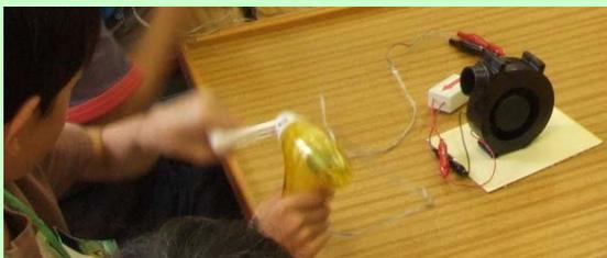
手回し発電機で送風機を動かし、風で電気を作る大変さを感じます
