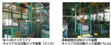
Ni-Cuメッキライン キャリア方式自動メッキ装置（ラック）
