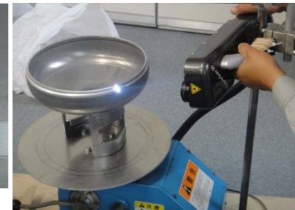
Al合金圧力容器の溶接前処理 (動画)
