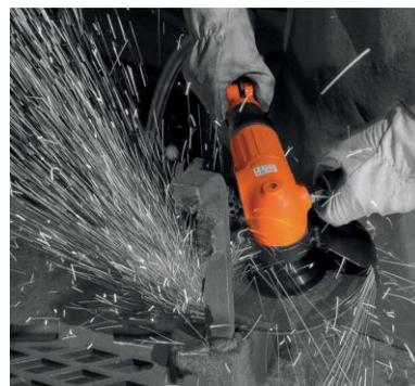
※造船所や橋梁建設現場、鑄造工場などにおけるバリ取り、面取り、溶接ビードの除去といった研削作業に使用される
