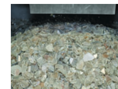
●ファンネルガラスの粉碎 ファンネルガラスは専用の機械で粉碎し50mm角程度の粒子（カレット）にした後で表面の付着物を除去した後、ブラウン管ガラスメーカーへ引き取られます。
