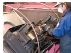
●各部品の取り出し ひとつひとつ手作業によって部品を取り出します。 電子銃や基盤などは様々な素材が混ざっているため、取り外した後、専門の処理工場に運ばれます。
