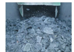
●パネルガラスの粉碎 洗浄した後、粉塵や騒音を抑えるために防音・防振設備のある部屋で粉碎を行います。 パネルガラスは50mm角程度の粒子（カレット）になるまで処理し、ブラウン管ガラスメーカーへ引き取られます。
