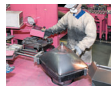
●ブラウン管の分離 パネルガラスとファンネルガラスの境目に照準を定めて、カッターで傷をつけた後でヒーター線を巻き付け通電することでブラウン管を切断します。
