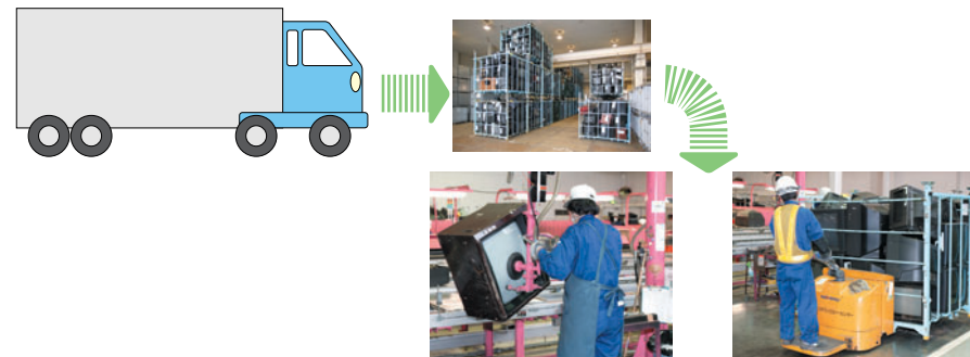
●ラインに搬入 工場に搬入された使用済みのテレビを解体のラインに乗せます。 ここがテレビのリサイクルのスタート地点です。
