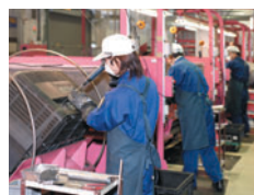
●キャビネットの取り外し キャビネット（筐体）を取り外すとブラウン管が出現します。
