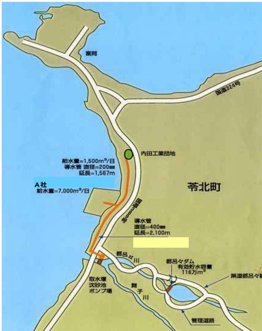
図 3.5.3 工業用水ユーザーへの供給までの配水管網図（荼北工業用水道事業）
