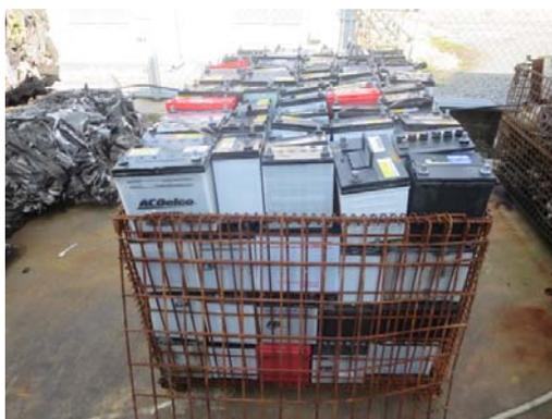
解体業者によって回収された廃バッテリーは、電気鉛を製造する一次製錬業者もしくは再生鉛を製造する二次製錬業者に販売される。製錬業者では廃バッテリーの解体および電解液の中和処理が行われた後、バッテリーケースはプラスチック資源として販売され、巢鉛（鉛を含む極板）は精錬されて、鉛製品としてリサイクルされている。
