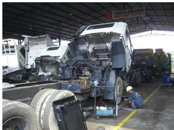
再生途中のトラック、内装が撤去され、エンジン周りを中心に徹底的な再生が施される。
