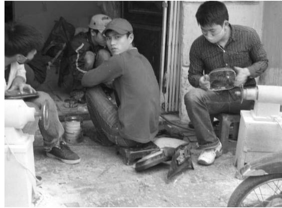
中古部品は店先において商品用に補修、洗浄が行われている。ヘッドライト（写真右）については全て分解し、内部を清掃した後新たに組み上げて販売を行っている。
