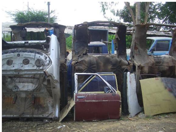
一見、ゴミの山に見える金属部品、ホース、擦り切れたシートなどもまだ再販売が可能な「商品」だと言う。切り離されたボディーも板金用の素材として再利用される。殆どの場合、ボディーはトーチを使って手解体されており、中古部品回収業者は、プレス機等の大型機械を持たない。
