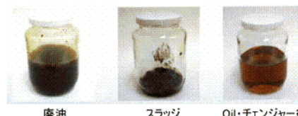
fuji oilチェンジャーで スラッジと清浄油に分離された廃油
