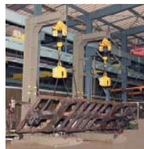
自社製大型反転機による作業
