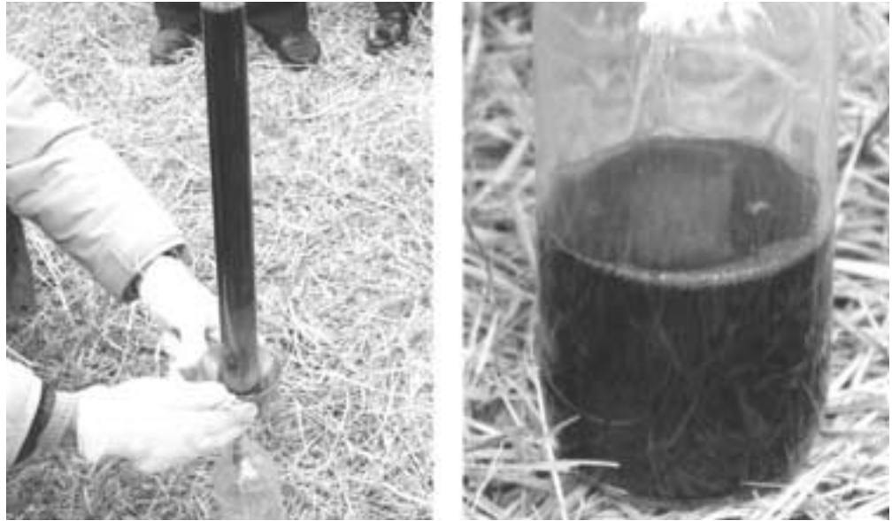
■ 図 2.2-6 地下に蓄積した廃油層から採取したサンプル（市原市）
