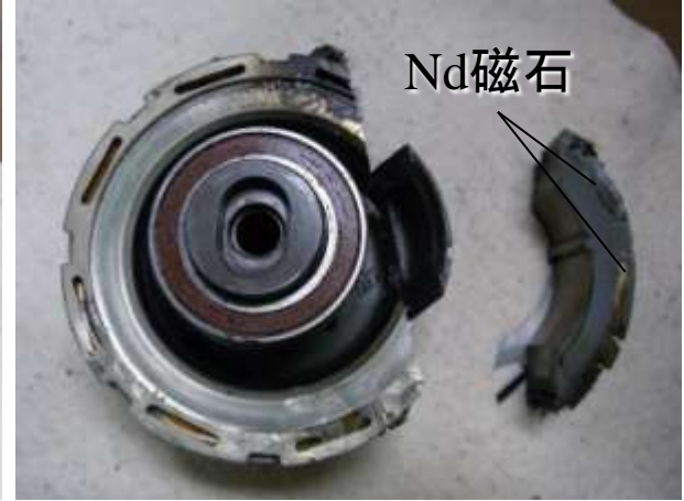
電磁鋼板切断 (内装Nd磁石)
