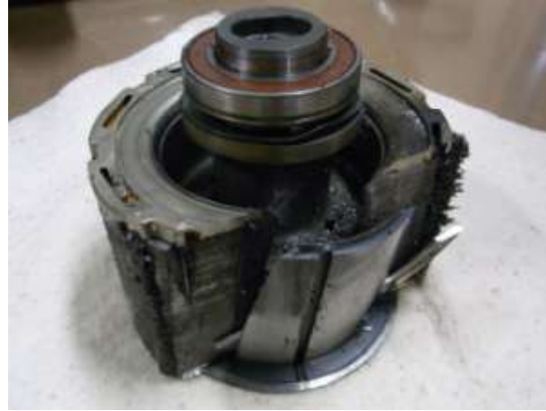
電磁鋼板切断(内装Nd磁石)
