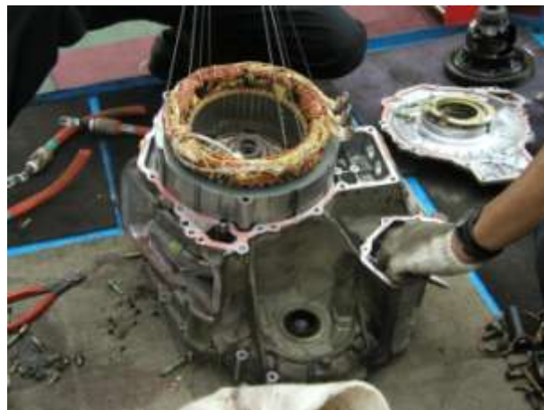
モーター取外し作業(コイル部)
