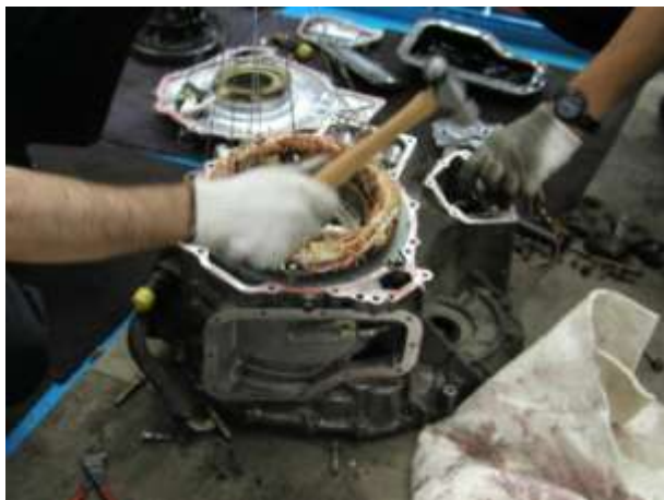
モーター取外し作業(コイル部)
