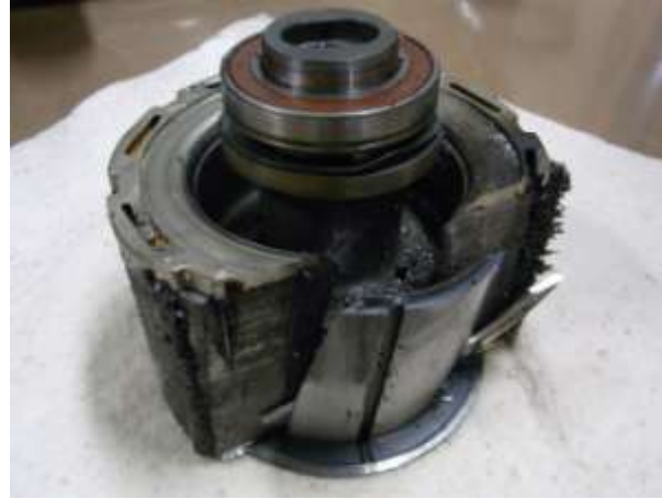
電磁鋼板切断(内装Nd磁石)
