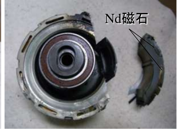
電磁鋼板切断 (内装Nd磁石)
