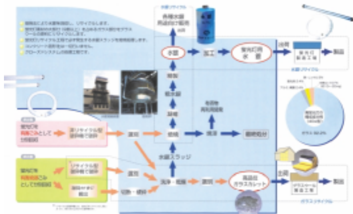
図2 高効率蛍光管リサイクルフロー (A社事例)
