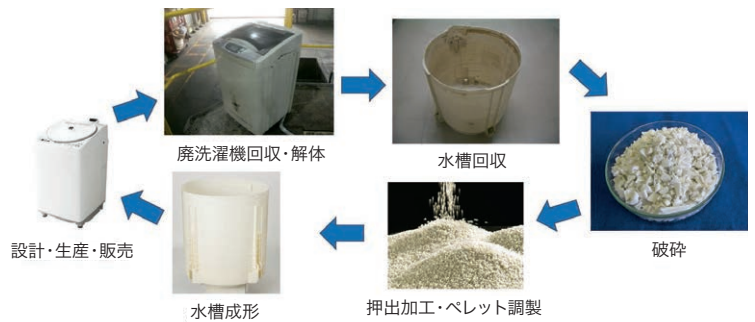
〔廃洗濯機水槽から新製品洗濯機水槽へマテリアルリサイクルの事例〕
